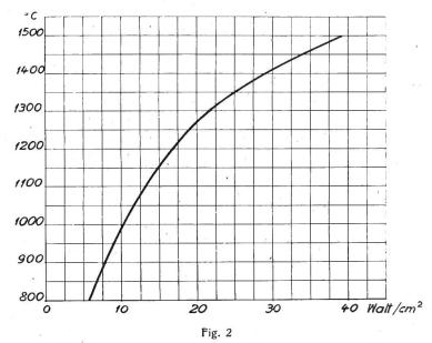
Spezifische Oberflächenbelastung eines Quarzilitheizkörpers von 7 mm Durchmesser und 190 mm Länge bei Temperaturen bis zu 1500 °C.
