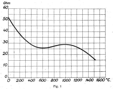
Widerstand eines Quarzilitheizkörpers in Funktion der Temperatur.
