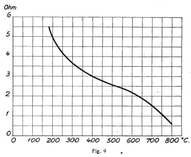
Widerstand eines metallisierten Quarzilitstabes in Funktion der Temperatur.
