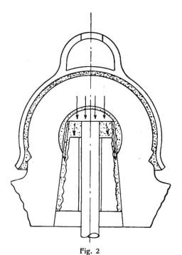
des Kittes auf Abscherung. (Fig. 2.) Ich muss infolgedessen starr kitten, wenn ich eine hohe Festigkeit erzielen will. Beim Kugelkopfisolator dagegen überträgt die Porzellankugel die Zugsbelastung auf den äusseren Porzellanscherben (vergl. Fig. 1). Das dazwischen liegende Füllmittel kann vollkommen elastisch hergestellt werden und
