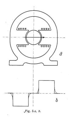
Denken wir uns die Zwischenräume zwischen den Polen immer mehr mit Eisen ausgefüllt, so wird aus Fig. 5a die Form 7a, bei der die Pole ihre ursprüngliche
