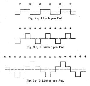
Durchflutungen der einzelnen Nuten als Vektoren darstellen, so erhalten wir Durchflutungs- und damit identische Felddiagramme, welche die Gestalt einer geraden Linie haben und bei welchen das Ende des Vektors der letzten Nut den Anfang des
