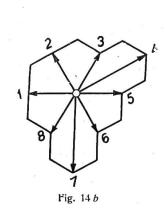
Dreiphasige aufgeschnittene Wellenwicklung mit verkürztem Schritt, für Polumschaltung, 6 w. 12 Pole. (Vollständiger Wicklungsplan vergl. Arnold, w. T., Bd. III, S. 137, Fig. 177 und 178).
