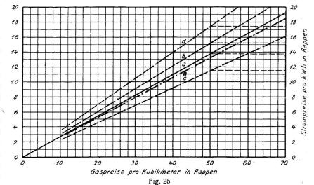
fuhr reguliert Werden Aequivalenzpreise zwischen 1 m³ Gas und 1 kWh elektrischer Energie bei verschiedenen An- und Fortkochversuchen.
