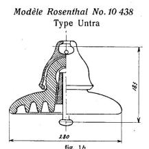
métallique. La tige n'est pas filetée, mais droite, et les fabricants se sont ingéniés à éviter tout effort excessif du ciment ou des ferrures sur la porcelaine. L'emploi de couche élastique sous forme d'enduit, laque ou paraffine, réduit la résistance mécanique de l'isolateur monté, mais permet encore d'atteindre 2500 kg pour l'isolateur suspendu courant et 3000 kg pour celui d'amarrage.
