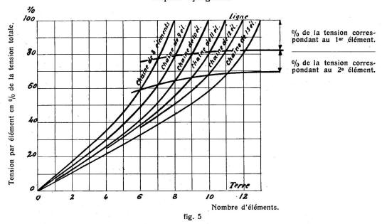
dont le premier élément supporte toujours environ 30% de la tension totale; les chiffres les plus bas s'appliquent aux chaînes d'isolateurs Ohio-Brass. Les isolateurs Jeffery-Dewitt nè se comportent pas mieux que les isolateurs Hewlett au point de vue de la répartition de la tension entre éléments comme le montrent les résultats du tableau ci-dessous tiré du Journal of A. I. E. E. de juillet 1920.
