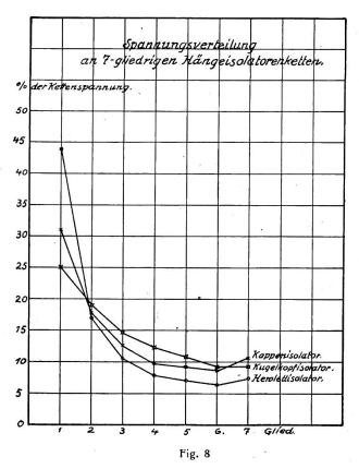
kann, dass für die Ionisierung der Luft und die damit bedingte Erhöhung der Kapazität der untersten Isolatoren keine Zeit mehr bleibt und der Isolator plötzlich entsprechend seiner Spannungsverteilung im normalen Betriebe überbeansprucht wird.
