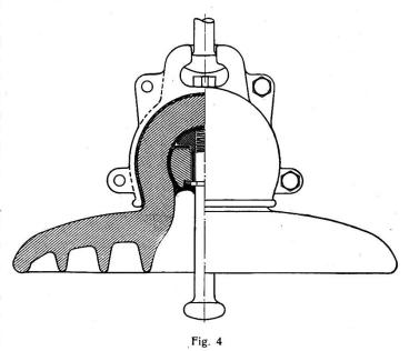
bei welchen der Hohlraum zwischen Kappe und Porzellankopf ebenfalls nur durch ein elastisches Zwischenmittel ausgefüllt ist.
