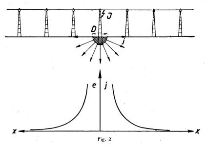
lauf in Fig. 2 dargestellt ist. Bei allseitig gleichmässiger Ausbreitung des Stromes ist auf jeder Halbkugelffäche, die im Erdinnern um den Eintrittspunkt geschlagen wird, die gleiche Stromdichte i vorhanden. Der Gesamtstrom ist daher für jeden Abstand x vom Mastfuss
