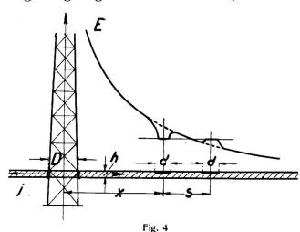
durch kräftige Regenschauer stark durchfeuchtet ist und verhältnismässig hohe Leitfähigkeit besitzt, während sich darunter eine dickere schlecht leitende Bodenschicht, etwa von ausgetrocknetem Sande, befindet. Der Erdstrom konzentriert sich dann zum grossen Teil an der gut leitenden Erdoberfläche.
