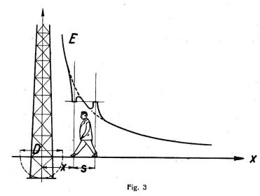
Umgebung der Fusspunkte, und zwar muss er sich so gross einstellen, dass unter der Wirkung seines eigenen Feldes und des vom Mast ausgehenden Erdstromfeldes die Spannungsdifferenz zwischen den beiden Fusspunkten gleich Null wird.
