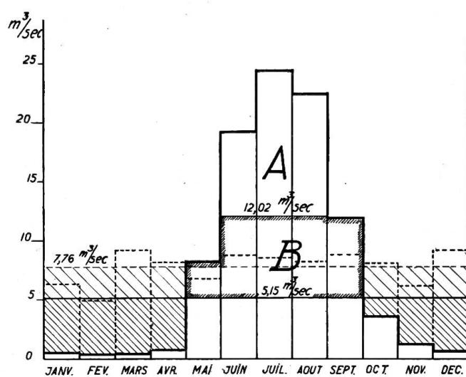
devrait être de  $6,23 \text{ m}^3/\text{sec}$  sans tenir compte de l'évaporation; vu l'évaporation il serait même bien inférieur à ce chiffre. Or on a constaté qu'il est en réalité de  $6,4 \text{ m}^3/\text{sec}$ .
