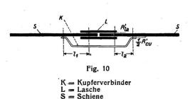
solche Länge den Abstand der Anschlusspunkte des Kupferverbinders zu wählen. Abgesehen davon, dass dann der Stosswiderstand bei verschiedenen Verbindungsarten über verschiedene Längen gemessen werden müsste, was sicher unerwünscht sein würde, zeigen auch unsere Messungen und Berechnungen, wie wir noch belegen werden, dass in fast allen Fällen der grösste Teil des Schienenstromes seinen Weg durch die Laschen und nur mit einem kleinen Teil durch die Kupferverbinder nimmt. Messen wir
