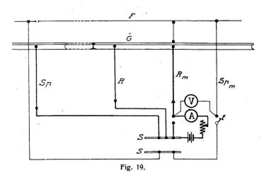
Schaltungsschema zur Messung des Widerstandes von Schienenspeisekabel.
