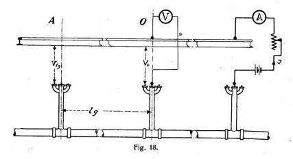
hat das Bureau of Standards in Washington angestellt <sup>1</sup>) über deren Ergebnisse wir noch berichten werden. Wir haben versucht, diesen Widerstand auf folgende Art zu bestimmen: <sup>2</sup>) Eine Batterie wird über einen Widerstand und ein Amperemeter zwischen Schienen und Rohrleitungen geschaltet und die Spannungen zwischen Schienen und Rohr an einem benachbarten Hydranten und einem weiteren, einige hundert
