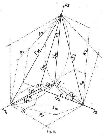
Spannungs- und Stromwerte ermittelt werden. In Fig. 8 können alle Spannungen ohne weiteres abgemessen werden. Sie sind in Tabelle I in die Kolonne "berechnet" eingetragen. Die Stromstärken  $J_1$ ,  $J_2$  und  $J_3$  ergeben sich zu:
