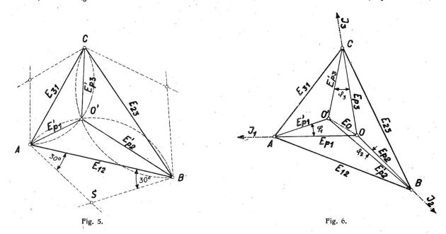
schneiden sich in einem Punkt, und dies ist der Nullpunkt für den Fall, dass keine der Phasen I, II oder III unterbrochen ist, also für den allgemeinen Belastungsfall nach Fig. 2. Die Strecken  $OA = E_{P1}$ ;  $OB = E_{P2}$  und  $OC = E_{P3}$  sind nach Grösse und Richtung die Phasenspannungen des Systems. Aus diesen Spannungen lassen sich die Ströme in den Widerständen ohne weiteres berechnen. Es ist:
