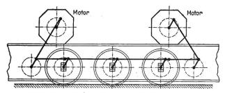
Antriebschema von Lokomotiven wie sie zuerst für die Veltlinbahn erstellt wurden; Typen 36 und 38; 1904 und 1906.
