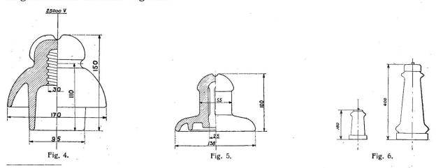
¹) Die komplette Tragbockkonstruktion ist für 10 000 Volt Betriebsspannung bestimmt. Im Normalbetrieb haben daher Tragbock- und Diaboloisolator je annähernd die Hälfte, also zirka 5000 Volt auszuhalten.
