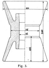
sicherheit und Oberflächenisolation bei trockenen und nassen Isolatoren. Diese Sicherheiten hängen in erster Linie von der Form und Oberflächenbeschaffenheit ab. Durch Anlehnung an die in der Praxis bewährten Formen können für Glas und Porzellan in dieser Beziehung gleichwertige Typen geschaffen werden.
