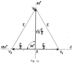
Bei der Bestimmung der Stromverteilung verfahren wir wieder wie früher, d. h. wir verlegen den Nullpunkt in eine der drei Dreieckseiten. Bei gleichen Spannungen E erhalten wir ein gleichzeitiges Spannungsdreieck, und die Potentiale  $V_1$   $V_2$  und  $V_3$  bestimmen sich der Grösse und Richtung nach zu:
