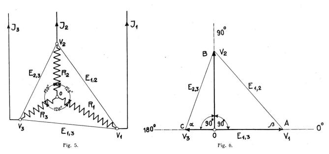
Die Spannungsdifferenzen  $E_{1,2}$ ,  $E_{2,3}$  und  $E_{3,1}$ , die zwischen je zwei Seiten bestehen, können wir uns durch drei Potentiale ungleicher Grösse entstanden denken, die eine Phasenverschiebung von  $120^{\circ}$  gegeneinander aufweisen. Es ist aber aus Fig. 5 leicht ersichtlich,
