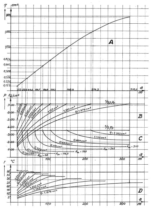
Kurven A: Grenzspannweiten für verschiedene Leiter-Querschnitte.
