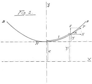
(Gewicht) pro Einheit der Länge (cm) sei = I. Im einfachsten Falle bedeutet also I das Gewicht von 1 cm Draht allein, es kann aber auch das Gewicht von 1 cm Draht nebst vorkommender Zusatzlast wie z. B. einer Schnee- oder Eiswalze sein. Das Polygon wird dann zur  $gew\"{o}hnlichen$ , Kettenlinie". Es wird nämlich in Fig. 2, wo H= die horizontale, V= die vertikale Komponente des im Seile wirkenden Zuges=P ist:
