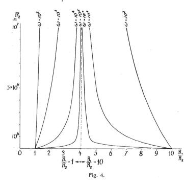
leitung). Und da Isolationen in ihrem Widerstandswert auch nie konstant bleiben, gibt es also eine untere Grenze der Frequenz, bis zu der statische Voltmeter mit Vorschalt-kondensatoren anwendbar sind. Je grösser die Kapazität  $C_1$  und  $C_2$ , desto niedriger ist diese Grenze.
