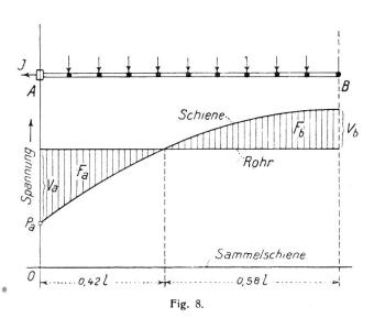
Die Steigerung des Spannungsanstieges in diesem Abstand über die Strecke  $d_x$  kann somit angesetzt werden zu  $dp=\frac{J}{l}(l-x)\cdot dx\cdot r_s$ , woraus sich für den Verlauf der Spannungsabfall in der Schiene der Ausdruck ableitet
