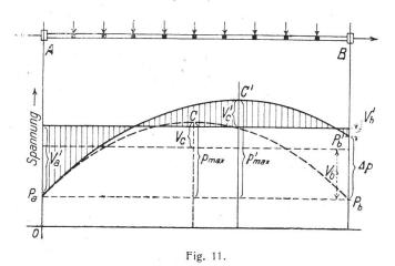
Der der neuen Verteilung des Schienenpotentials entsprechende maximale Spannungsabfall  $p'_{max}$  (siehe Fig. 11) steht in folgender Beziehung zum Wert  $p_{max}$  bei gleichem Potential der Speisepunkte:
