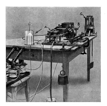
Fig. a Kleiner Versuchschalter 250 V, 100 A für die Versuche in den Techn. Prüfanstalten des S.E.V. benutzt.
