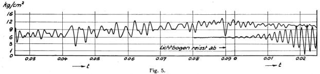
Druckverlauf im Innern des geschlossenen Oelschalters. Statischer Druck = 6 kg/cm<sup>2</sup> absolut.
