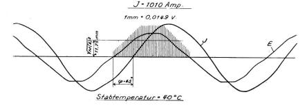
Fig.4 Eichlinie für Messungen am werseilten Leiter 13:36
