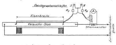
aub - Anschluss-Stellen für die Spannungsmessung
