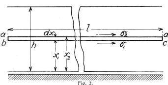
Das senkrecht durch die Barren eintretende Streufeld hat naturgemäss zur Folge, dass nunmehr in den Stäben Wirbelströme induziert worden, welche in der Hauptsache der Stabrichtung folgen. Betrachten wir zwei solcher Stromfäden (Fig. 2) im Abstande  $x_1$  und  $x_2$  von der Länge I (der Armatur) und vernachlässigen wir den elektrischen Widerstand der Endverbindungen ab und cd, so ist der *Widerstand* eines einzelnen Stromfadens
