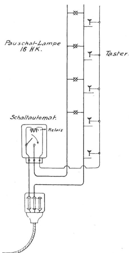
B. Installation f. 4 flämige Treppenbeleuchtung mit Dauer- u. Dämmerlichtbeleuchtg
