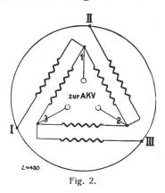
Hat der Motor eine bestimmte Tourenzahl erreicht, so werden die Punkte 1, 2, 3 kurzgeschlossen; es kann dann in jedem der 6 Wicklungsteile 1—2, 2—3, 3—1, 1—I, 2—II, 3—III der normale Belastungsstrom fliessen, so dass der Motor wie ein gewöhnlicher Asynchron-Motor
