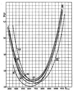
Fig. 13. Verhältnis  $\frac{b_a}{g_a}$  als Funktion der Induktion bei verschledenen Periodenzahlen.
