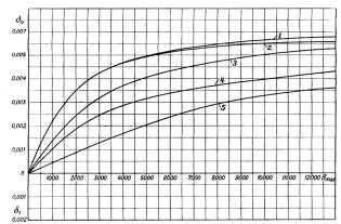
Fig. 14. Aequivalenter Luftweg der Stossfugen und Verzapfungen bei Transformatoren als Funktion der Induktion.
