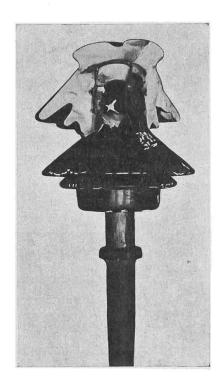
Fig. 8. Isolateur fondroyé. (Union d'essai 90 000 volts.)
