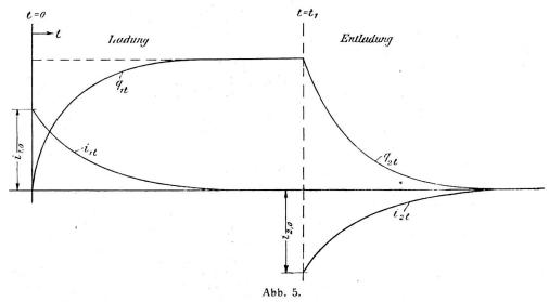
Ladung und Entladung eines Kondensators bei Gleichstrom über einen induktionsfreien Widerstand.
