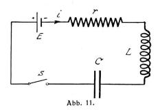
Die Dämpfung der Schwingungen verhielten sich wie 72:65:53, war also wie 1,36:1,18:1,00 gestiegen. Die Verwendung von Eisendraht statt Kupfer hatte bei einer andern Spule einen Induktivitätsgewinn von 10% zur Folge.
