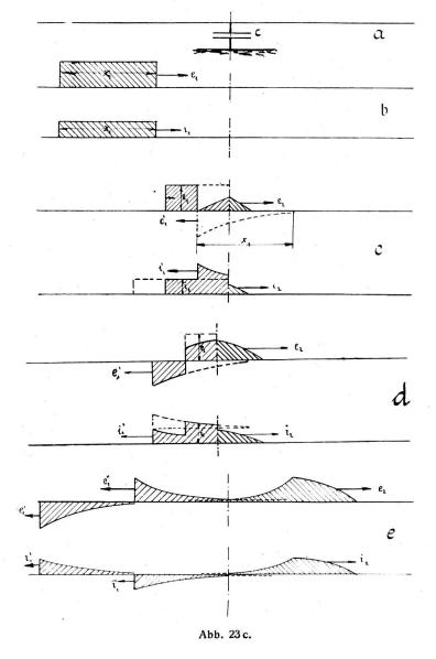
wiesen,\*) insbesondere auf den wichtigen Umstand, dass der Schutzkondensator nur einen langsamen Anstieg des Potentiales an den Maschinenwicklungen zulässt.
