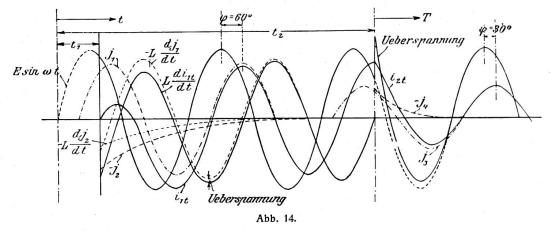
Verlauf von Strom und Spannung beim Einschalten und Regulieren des Stromes in einer Induktionsspule bei Wechselstrom.
