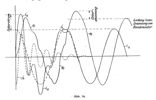
Verlauf von Ladung und Strom bei Wechselstrom kurz nach dem Einschalten wenn  $R^z \, C < 4 \, L$  ist, jedoch noch keine Resonnanz zwischen aufgedrückter und freien Schwingungen auftritt.
