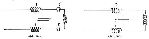
Maschinenwicklung ist infolge direkter elektrischer Kopplung besonders an den ersten Windungen Gefahren ausgesetzt. Man muss daher durch Einschalten einer weiteren Drosselspule L' gewissermassen die ersten Windungen des Transformators nach aussen, in L' hinein, verlegen. Abb. 26 b. Einer solchen Schaltung kommt natürlich für die Zwecke der Starkstrom technik keine Bedeutung bei, wenn es einem darauf ankommt, Komplikationen einzuschränken.
