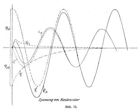
Verlauf von Ladung und Strom bei Wechselstrom, wenn  $R^2C > 4L$  ist.
