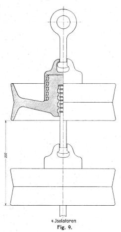
fung unterzogen. Die verwendeten 4gliedrigen Ketten besitzen bei 70 000 Volt Betriebsspannung und 5 mm Regen p. Min. unter 45° ca. 3fache Sicherheit gegen Ueberschlag. Die an einer Kette vorgenommene Zerreissprobe ergab Abreissen des Porzellans unterhalb der Kappe bei 4500 kg.
