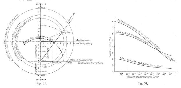
Der einfacheren Darstellung wegen wurden die geringen durch die Veränderlichkeit des magnetischen Widerstandes des Relais bedingten Abweichungen nicht berücksichtigt. Aus dem Kreisdiagramm geht hervor, dass zu jeder Einstellung ausser den bereits besprochenen vier charakteristischen Auslösewerten nach a) noch ein neuer Wert hinzukommt für Auslösestrom bei Normalspannung und  $\cos\varphi=+0$  z. B. 3,7 Amp.
