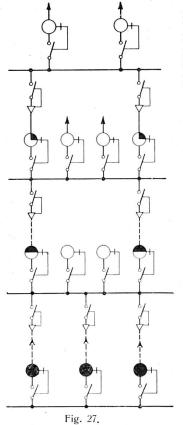
Bei Auftreten eines Kurzschlussstromes wird der Ring z. B. in der Unterstation 3 durch ein Momentan-Maximalrelais aufgeschnitten, wodurch der gesunde Sektor des Ringes vom Fehler isoliert ist. Im fehlerhaften Sektor wird dasjenige Maximalstrom-Zeitrelais auslösen, das der Fehlerstelle vom Speisepunkt aus am nächsten ist. Durch eine Hülfs-
