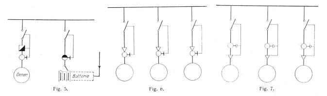
Die Kritik der Schemata für Generatorrelais lässt uns die interessante Beobachtung machen, dass bei einzeln arbeitenden Generatoren Defekte in den Wicklungen, und bei Kommutatormaschinen Ueberschlag zwischen den Bürsten etc. die ausserhalb der Maschinen eingebauten Maximalstromrelais nicht zum ansprechen bringen und die Maschinen gegen eine zunehmende Zerstörung durch den Lichtbogen an der Fehlerstelle nicht geschützt sind.
