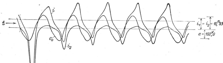
Abb. 13. Transformator I belastet, II unbelastet. i = Gesamtstrom i_2 = Strom im Transformator II } beim Einschalten von Transformator II. e_0 = Spannung. R = 1,04 \text{ Ohm} .
