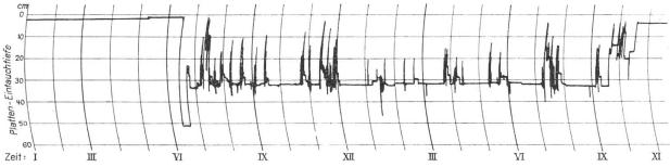
Abbildung 5. Widerstandsregulierung des Generators in Brig am 5. Oktober 1912.
