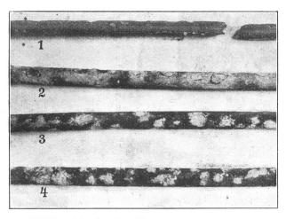
Abbildung 16. Oxydierte Kontaktdrähte aus Kupfer.
