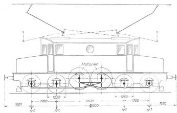
Abbildung 18. Neuere Simplonlokomotive, Bauart Fb 4/4.
