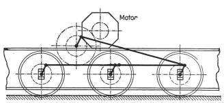
Abbildung 10. Antriebsschema der Lokomotive der Pennsylvaniabahn.
