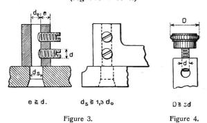
§ 13. La tabelle ci-dessous indique le nombre et le diamètre des vis, ainsi que le diamètre qu'il convient de donner normalement au trou destiné à recevoir le conducteur.
