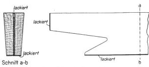
Abbildung 6. Ueberziehen der Kommutatorsegmente mit Isolationsschichten.
