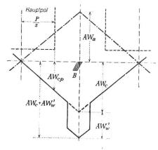
Abbildung 4. Verlauf der Anker- und der Kompensations-AW;  $B = B\ddot{u}rstc$ .
