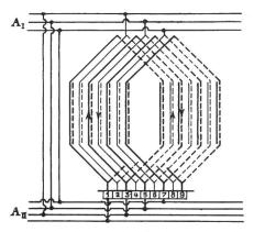
Abbildung 5. Zweifache Schleifenwicklung, bezw. zweifache Parallelschaltung: 2a = 4p.
