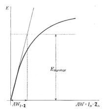
Abbildung 2. Bestimmung von  $AW_l + \varepsilon$  aus der Leerlaufscharakteristik.
