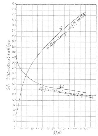
Abbildung 9. Abhängigkeit des Widerstandes der Kohlenfadenlampe und der Wolframlampe von der Spannung.
