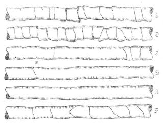
Abbildung 14. Mikroskopische Präparate von Tantal- und Wolfram-Fäden.
