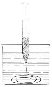
Abbildung 1. Experiment zur Darstellung der Kohlenfaden nach Swan.
