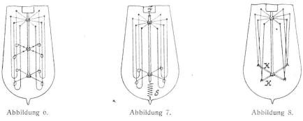
Abbildungen 6 bis 8. Fadenhalter-Konstruktionen verschiedener Metallfadenlampen.
