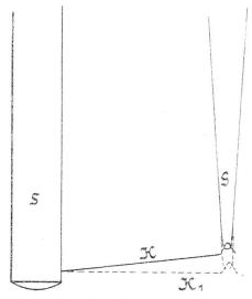
Abbildung 13. Schwingungen des Fadenhalters von Wolframlampen beim Ein- und Ausschalten.
