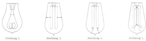
Abbildungen 2 bis 5. Fadenhalter-Konstruktionen der Kohlenfadenlampe (Abb. 2) und verschiedener Metallfadenlampen.
