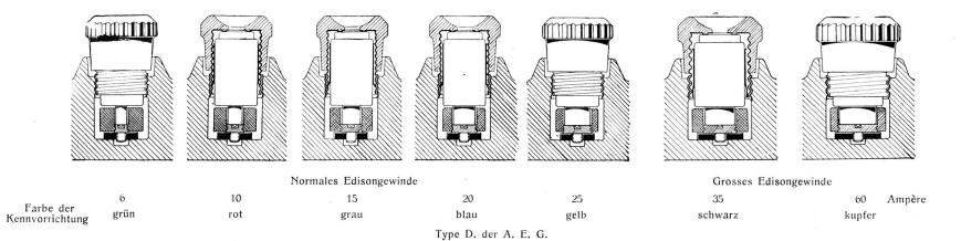
der Fusskontaktdurchmesser mit zunehmender Stromstärke, wie aus Abbildung 3 ersichtlich ist. Ein Vorteil ergibt sich durch die Verwendung von Patronen kleinerer Stromstärken in grösseren Elementen. Die Lagerhaltung wird hierdurch wesentlich vereinfacht.
