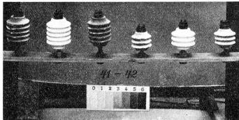
Abbildung 8. Rillenisolatoren der Bernischen Kraftwerke.
