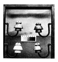
Abbildung 5. Bahnüberführungsisolatoren der Bernischen Kraftwerke.
