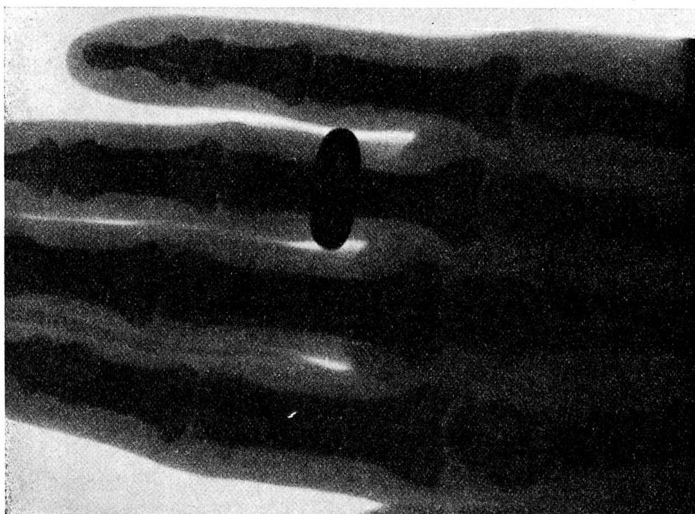
Figure 29. Autotypie d'une radiographie due à des rayons X engendrés dans une ampoule radiogène par la haute tension asymétrique d'un transformateur de 100/100\,000 volts. (Sa reproduction ne rend pas les nuances du négatif radiographique.)
