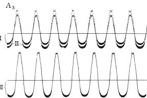
Figure 14. Oscillogrammes relatifs à l'induit à tambour I et II, en charge sur résistance non inductive de 0,59  $\Omega$ 480 tours/minute et 7700 ampères-tours.
