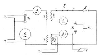
Figure 22. Schéma du dispositif utilisé pour la production d'un courant intermittent.
