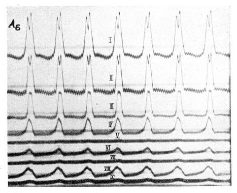
Figure 16. Autotypie d'oscillogrammes touchant le fonctionnement à vide (I, II, III) et en charge (IV, V, VI, VIII, IX) de l'enroulement complémentaire de l'induit à anneau.
