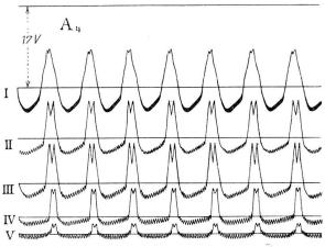
Figure 15. Oscillogrammes pris à vide aux bornes de l'en-roulement principal de l'induit à anneau.
