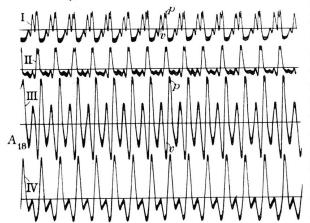
Figure 24. Oscillogrammes indiquant la déformation des ondes de tension et de courant de la machine par un transformateur de haute tension.
