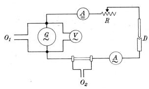
Figure 32. Schéma de l'agencement utilisé pour la production d'un arc voltaïque.
