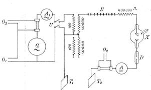
Figure 30. Schéma du dispositif employé pour la génération de rayons X.
