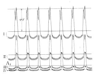
Figure 13. Reproduction d'oscillogrammes concernant le fonctionnement à vide de l'induit à tambour.
