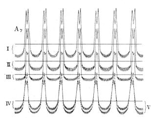
ure 17. Oscillogrammes regardant le fonctionnement à vide (I. II, III) et en charge (IV, V) des deux enroulements de l'induit à anneau, mis en série.
