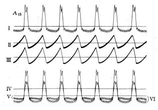
Figure 20. Oscillogrammes relatifs à la mise en courtcircuit de l'enroulement principal de l'induit à anneau; I, II et III en charge inductive, IV, V et VI à vide.
