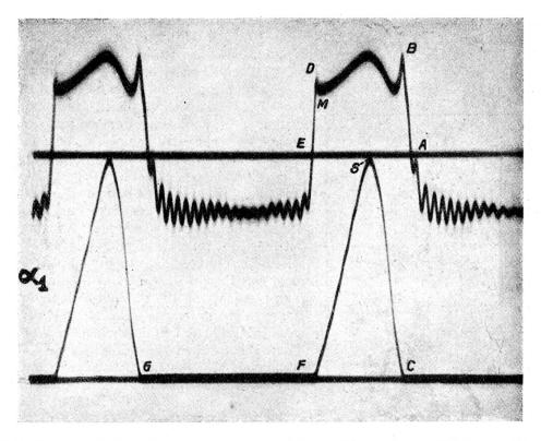
Figure 33. Autotypie des oscillogrammes se rapportant à l'arc voltaïque créé par la F. E. M. asymétrique. ABMD = Tension aux bornes de la machine, 30 volts effic., 1620 tours minute, 3150 ampères-tours. CSFG = Courant, 15 ampères effic., 7,6 ampères en moyenne arithmétique.
