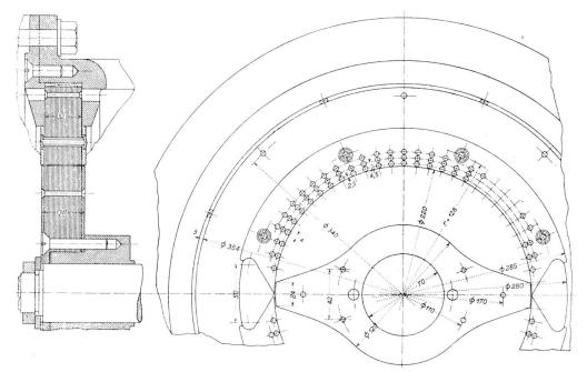
Figure 27. Croquis coté de la machine d'essai nº 2.
