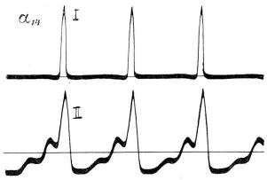
I = Forme du courant traversant l'ampoule radiogène = cou-Courant primaire du transformateur  $^{100}|_{100000}$  = courant d'induit de la machine.
