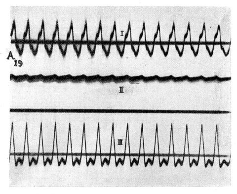
Figure 25. Oscillogrammes touchant la génération d'un courant continu.
