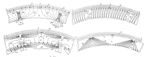
Figures  $\begin{bmatrix} 2, & 3, \\ 4, & 5. \end{bmatrix}$  Types divers d'inducteurs et d'enroulements.
