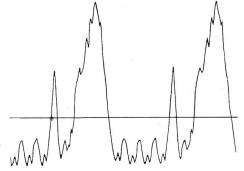
Figure 9. Reproduction de l'oscillogramme d'une force électromotrice induite dans une spire d'anneau Gramme par un inducteur homopolaire spécial.
