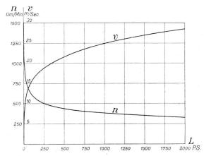
Abbildung 4. Berechneter Zusammenhang für Umdrehungszahl und Leistung, sowie für Umfangsgeschwindigkeit und Leistung bei normalen elektrischen Maschinen.
