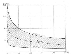
Abbildung 1. Umdrehungszahlen von normalen Gleichstrommaschinen nach R, Goldschmidt,
