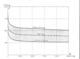
Abbildung 2. Abhängigkeit des Dimensionierungs-Koeffizienten C von der Maschinengrösse.
