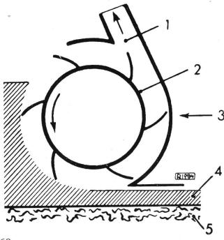
Diese letztere Maschinentype wird überall da verwendet, wo ein schichtenweises Arbeiten nicht notwendig ist, wo also mit den Pneurädern auf festem Boden gefahren werden kann. Die schematische Darstellung des Fräsaggregates erklärt das eigentliche Arbeitsprinzip:
