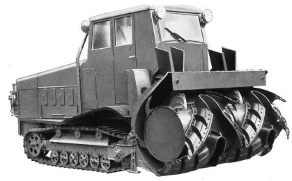
stets dasjenige Quantum Schnee zuzuführen, welches sie zu bewältigen vermögen. So wird z. B. beim Ausfräsen von harten Eissohlen die Fahrgeschwindigkeit entsprechend reduziert.
