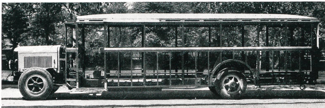
Omnibus mit Stahlgerippe (ausgeführt von den Carrosseriewerken Bern, Ramseier, Streun & Cie.)
