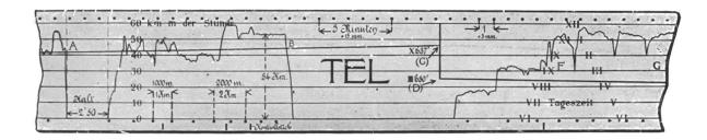
Registrierender Geschwindigkeitsmesser «TEL» für Automobile mit Diagramm.
