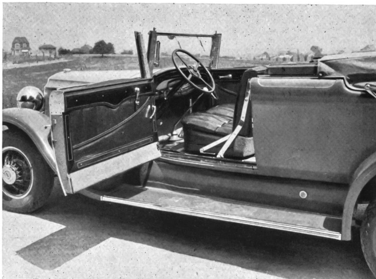
Carrosserie K. Egli, Basel: Spezial-Rollsitz für Cabriolet mit nur zwei Türen. Sitz in normaler Stellung.
