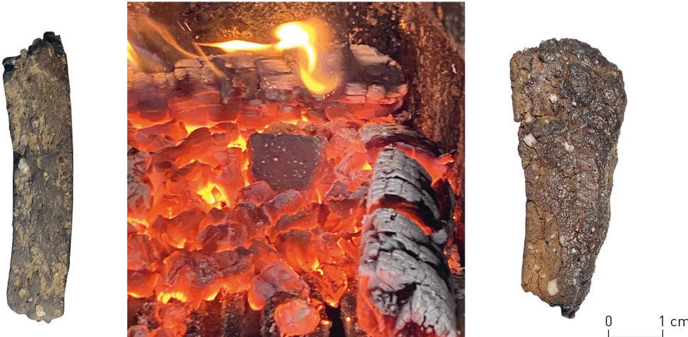
5 Eine prähistorische Scherbe (links) entwickelte bereits nach 20 Minuten in der Glut Blähton (rechts).
