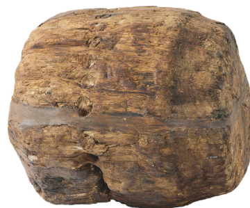
3 Nabe des Wasserrads aus Eiche mit 27 Löchern für die Schaufeln.
