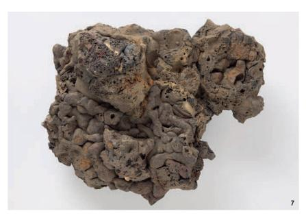
Abb. 7 Grau-dichte Fliessschlacken sind typisch für die frühmittelalterliche Eisenverhüttung in Büsserach.
