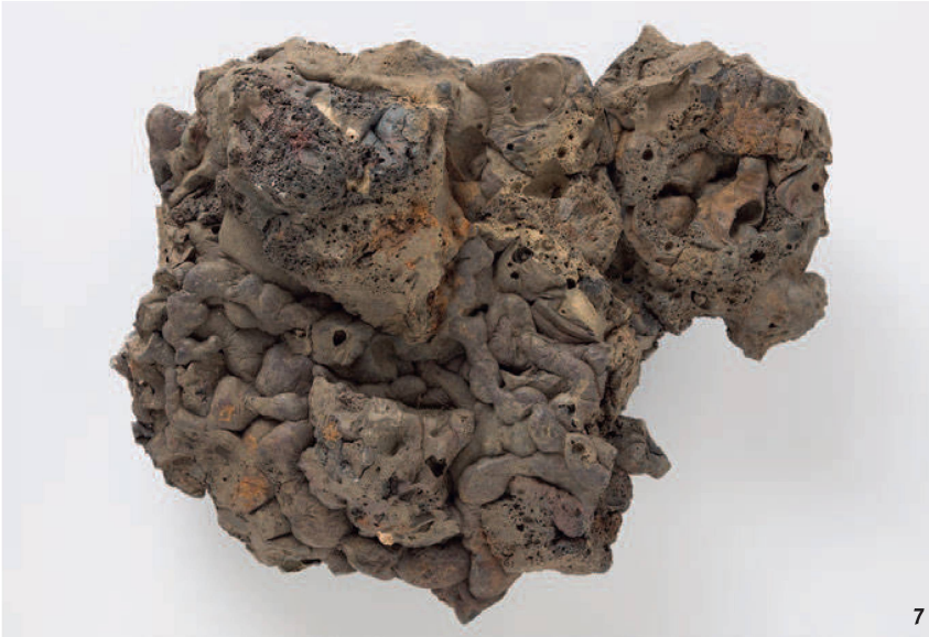
Abb. 7 Grau-dichte Fliesschlacken sind typisch für die frühmittelalterliche Eisenverhüttung in Büsserach.
