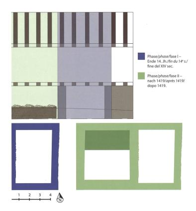
Abb. 3 Grundriss und Längsschnitt durch die St. Michaelskapelle in den Bauphasen I–II.
