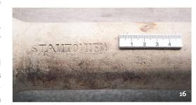
Abb. 16 Detail: Gepresste Röhre mit Herstellerstempel «ST:ANTONIEN».
