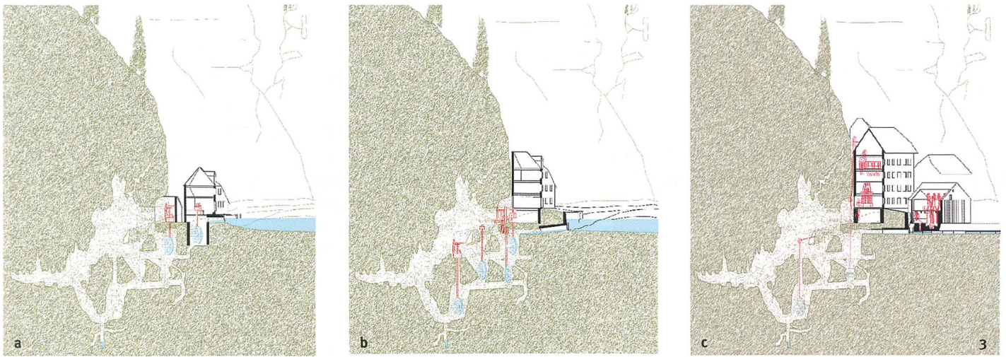
Abb. 2 Fundstellenplan. 1) Höhle; 2) Abfluss mit Transmissionsgang; 3) Mühle von la Roche (1651); 4) Erweiterung der Mühle (1856); 5) Mühle (1739); 6) «Zisterne»; 7) Zisternen-Mühle (1651); 8) Transmissionsgang (1856); 9) Staumauer und Fassung (1651); 10) Hydraulikpumpe (19. Jh.); 11) Landwirtschaftsgebäude (18. Jh.); 12) Gattersägen (1856); 13) Sägewerk (1856); 14) Kreissäge (1856); 15) Zuleitung (1805); 16) Speicherteich (17.-18. Jh.).
