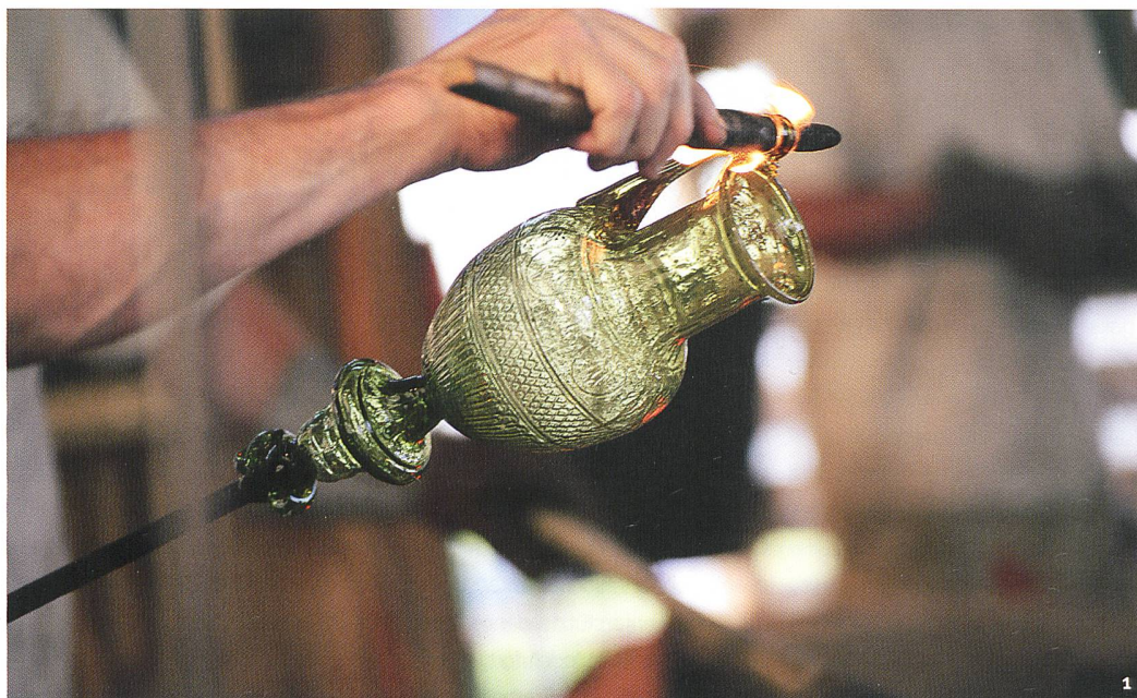
Abb. 1 Der Ennion-Krug während der Produktion. Hier wird gerade der Henkel ausgearbeitet.
