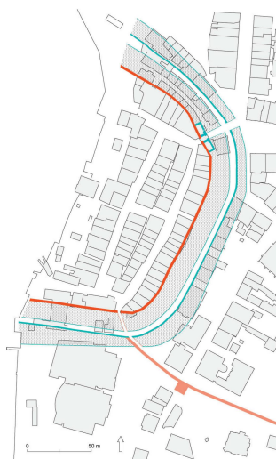
Fig. 45 La ville de Zoug, fondée au début du 13 e siècle, n'a d'abord eu pour fortification qu'une enceinte sans tours (rouge). Sous les Habsbourg, l'enceinte a été progressivement renforcée par la tour de l'Horloge (Zitturm) et un mur de contrescarpe (bleu).
